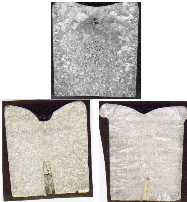
Figura 5: Metalografia dos lingotes vazados em moldes de aço.
