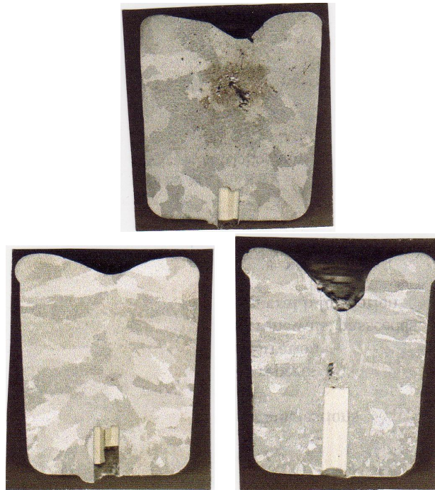
Figura 6: Metalografia dos lingotes vazados em moldes de areia.
