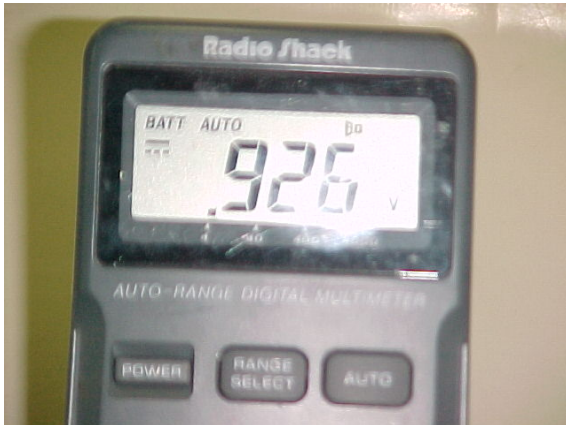
Figura 5: Quando soprado ar, atingiu-se 0,9V.
