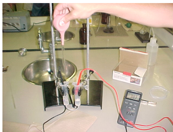
Figura 4: Mais eletricidade é produzida se ar for soprado no compartimento catódico.
